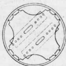
Рис. 95. Крепление электродов и центровка арматуры лампы в колбе при помощи слюдяного изолятора
