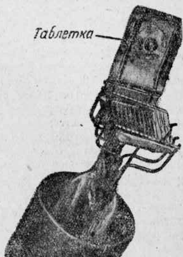
Рис. 109. Крепление термитной таблетки в лампе с бариевым катодом (анод разрезан и отогнут).
