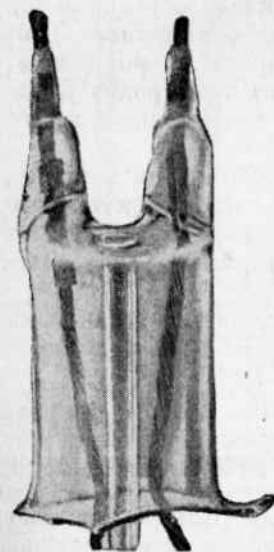
Рис. 52. Вольфрамовые стержни в качестве вводов накала в ножке мощной проекционной лампы.
